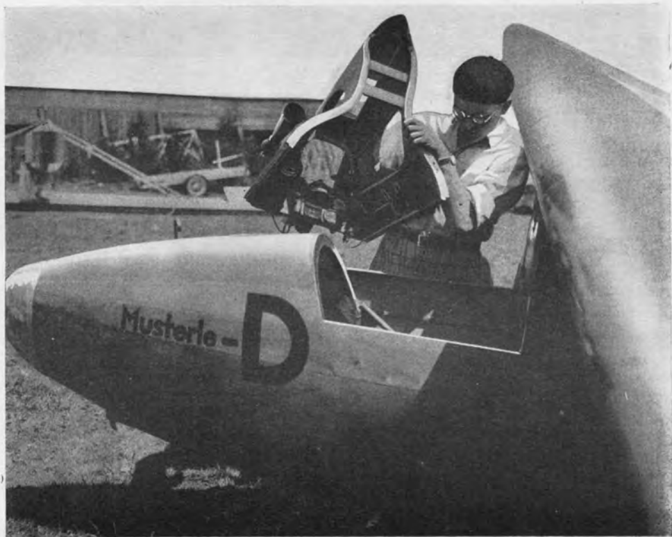
Wolf HIRTH devant le « Musterle » dont l'instrumentation est groupée dans la capote amovible.
