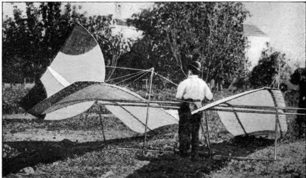
Vérification des commandes du gouvernail de profondeur avant le départ, le 16 mars 1905.
