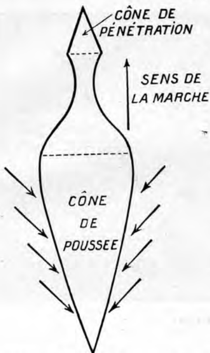
Schéma de l'effet aérodynamique COUSIN.
