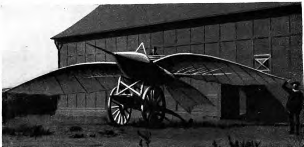
Appareil n° 2, à Brest, en 1865 — LE BRIS est à bord. La voiture servait de point d'envol fixe.
