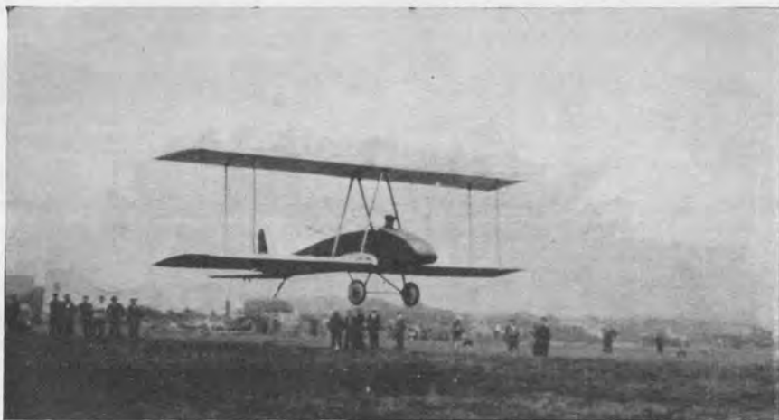
Biplan Ferber piloté par Robert FERBER. On distingue le fuselage à forme de profil d'aile.
