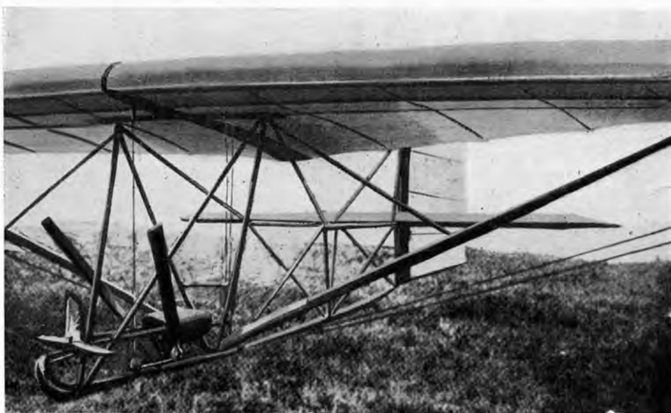
Système de timonerie des appareils HARTH.
